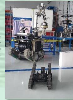
Binôme de robots pour manipulation de vannes
